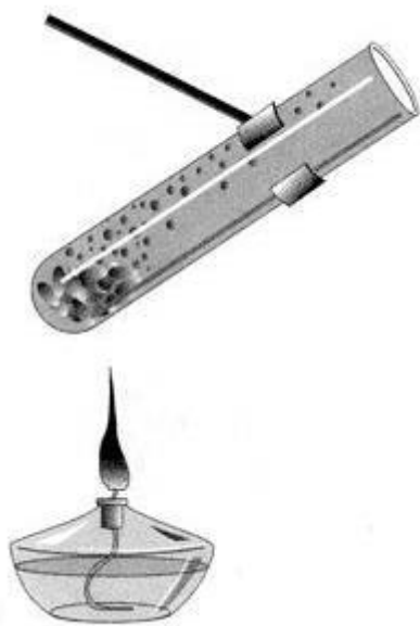
Рис. 1. Нагревание жидкости в пробирке на спиртовке.
